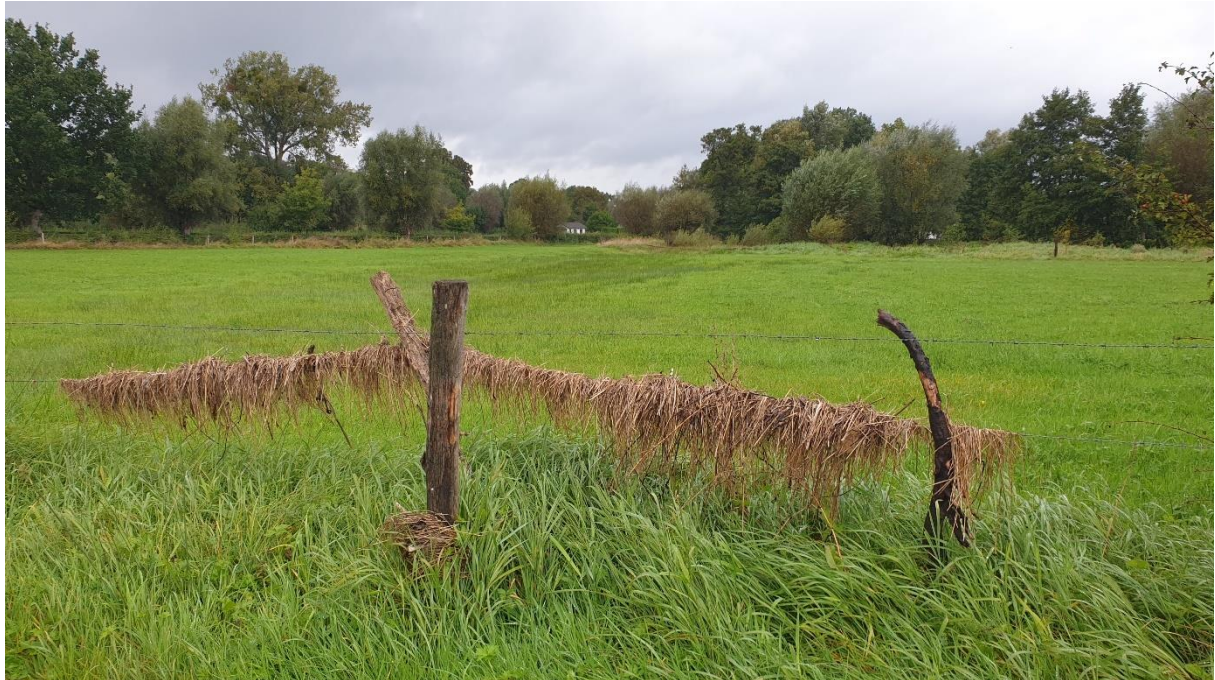
Figuur 63: Vloedmarkeringen waaruit de afvoer is geschat tijdens een veldbezoek in september 2021
