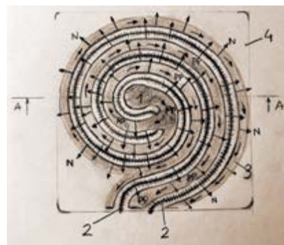
Rys. 1b. Schemat indukcyjnego panelu klimatyzacyjnego bez wentylatora z dopływem powietrza świeżego (wersja sufitowa)
