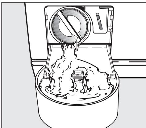
■ Løsne lofilteret til vannet renner ut.
