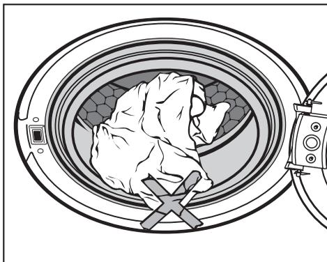
Pass på at ingen tekstiler blir klemt fast mellom døren og dørpakningen.
