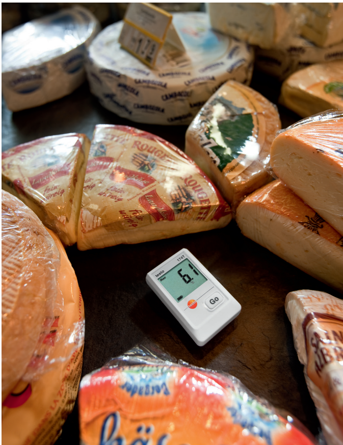
Fig. 16: Ved temperaturovervåking i ostedisken brukes testo 174T
