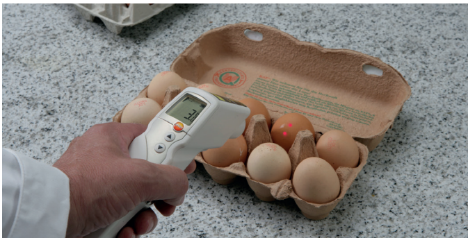
Fig. 5: Infrarød måling av overflate på mat.
