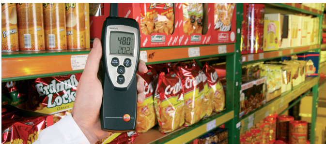
Fig. 10: Fuktighetsmåling av varer i dagligvarehyller
