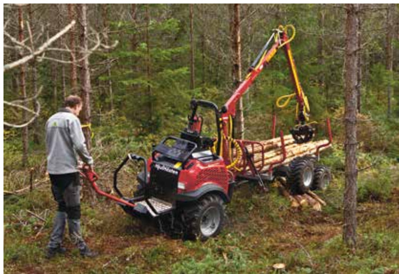
Hjulhesten med kran er et aktuelt transportmiddel for vedprodusenter, også under tynning.
