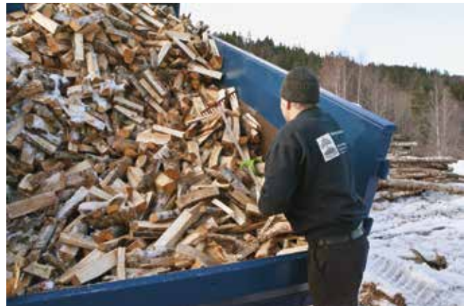
Planet til en lastebil med tipp benyttes som stablebord. Ei stålrive er effektiv for å få ned kubbene.
