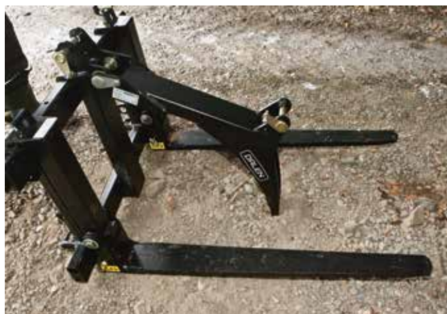
En Dalen universalklo benyttes både til å legge på råvirke og til å transportere storsekkene.
