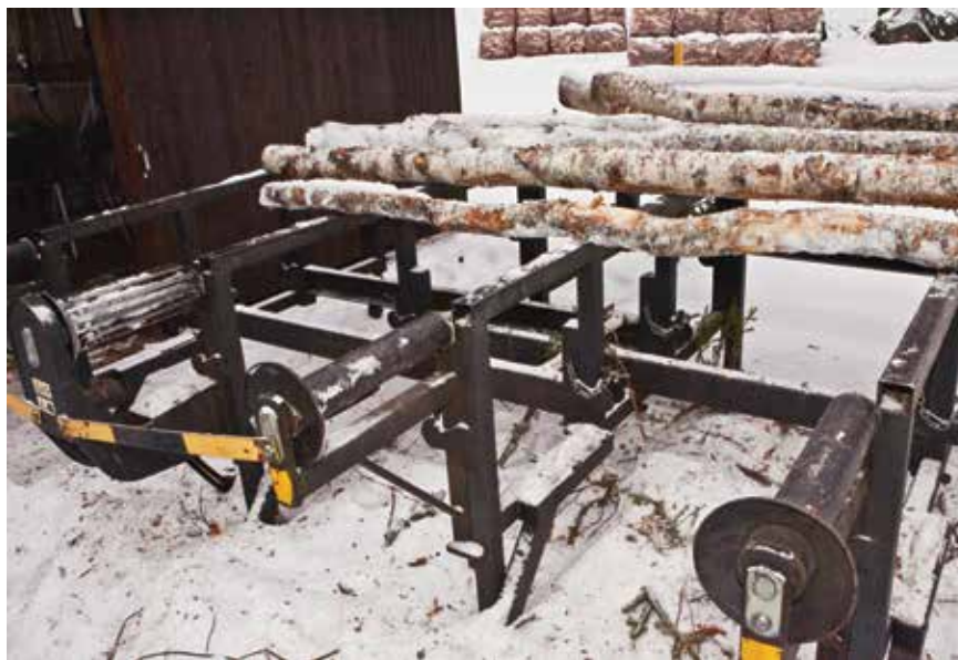
Geir har sveiset på et par ekstra underliggere på matebordet for å hindre at korte stokker detter ned med ene enden.
