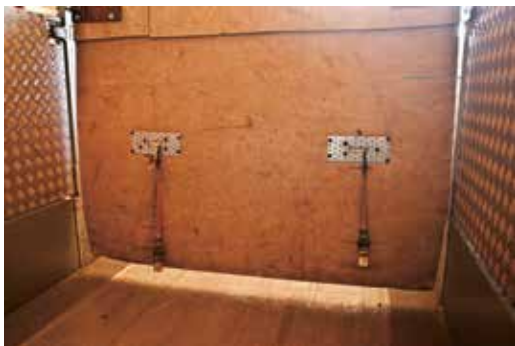
Tippengeren har en finerlem i midten. Denne er kun fastmontert øverst, et strammeband holder lemmen på plass nederst. Derved kan veden tippes suksessivt fra de to rommene.
