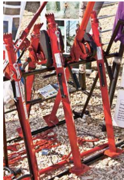
Det svenske firmaet Reipal har utviklet praktiske fellejekker.
