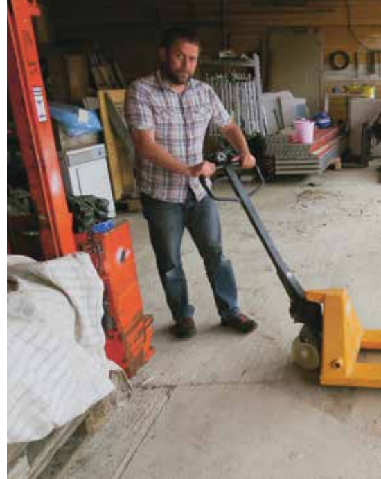
Ei jekketralle benyttes for å flytte vedsekkene for midlertidig plassering i hallen før utkjøring av «nykløyvd» til kunde, eller til tørkeplass.
