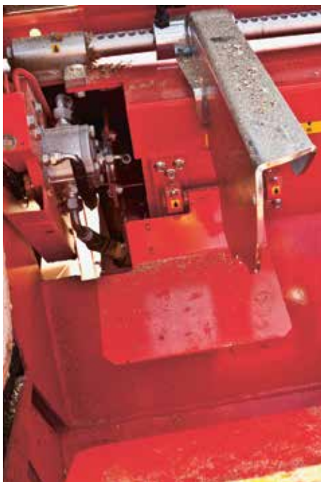
Landingsplattformen er praktisk for senke kubbene før kløyving.
