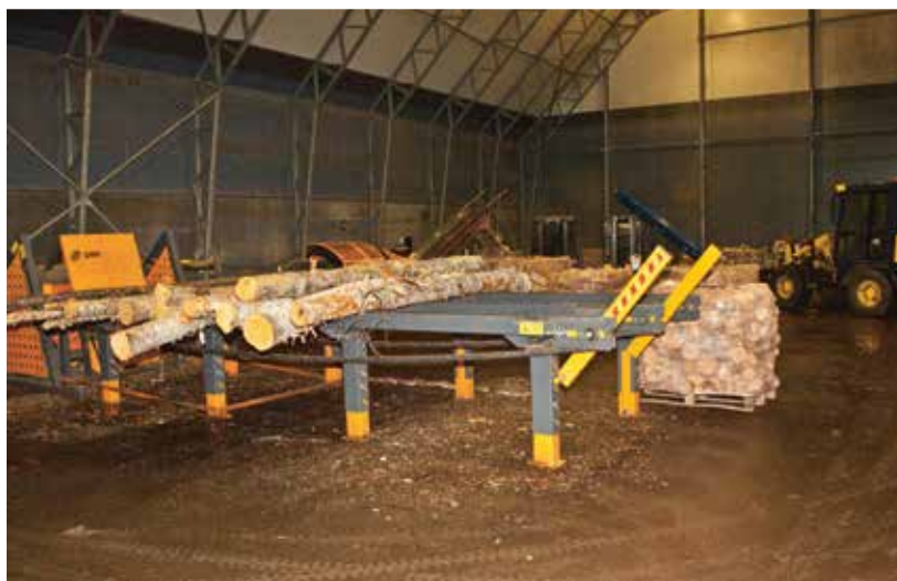
Sami Autochopper er en helautomatisk vedmaskin.
