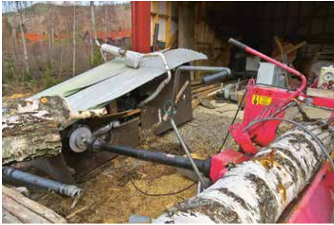
Motoren fra en Mercedes 300 personbil er kraftkilden til vedmaskinen.
