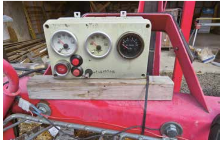
Betjeningspanelet til Mercedes-motoren er festet på vedmaskinen. Her kan motoren startes og stoppes, og han kan følge med på temperatur og oljetrykk.
