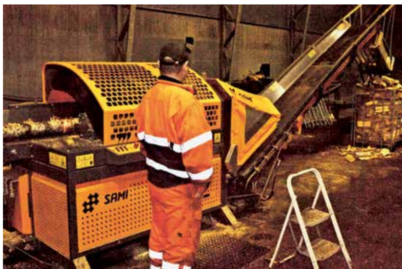
Sami Autochopper er en helautomatisk vedmaskin.
