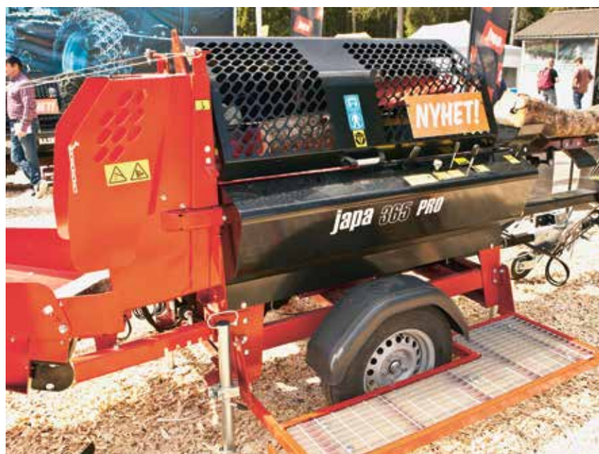
Japa kom også med en transportabel versjon av sin vedmaskin 365. Den er altså utrustet med hjul og kan transporteres som tilhenger.
