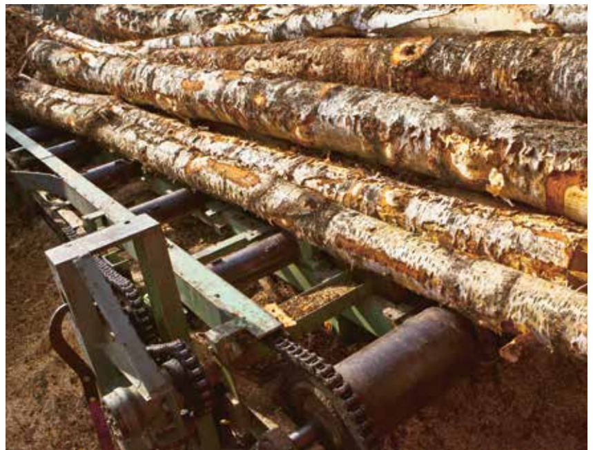
Stokkene hentes med kranhenger og legges på innmatingsbordet som ikke har kjededrift. Stokkene rulles inn til en innmater med drift, en selvlaget løsning, og kjøres så inn på vedmaskinens matebord.
