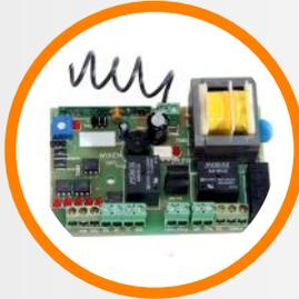
Placa microprocesada BAS V4 SMD con manejo de apertura y cierre a un pulso. Cierre temporizado, embrague anti-aplastamiento, ralentización optativa y salida para fotoeléctrica.
