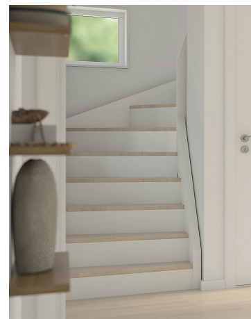
Tät trappa i furu med vitmålad vang och sättsteg, plansteg i furu vitlaserade. Handledare och räcke i vitlaserad furu, typ Funk 11
