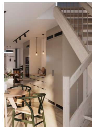
Trappa, Hus 128 kvm Öppen trappa i vitlaserad furu inkl. vang. Handledare och räcke i vitlaserad furu, typ Funk 11 (spjälör av rostfritt stål).
