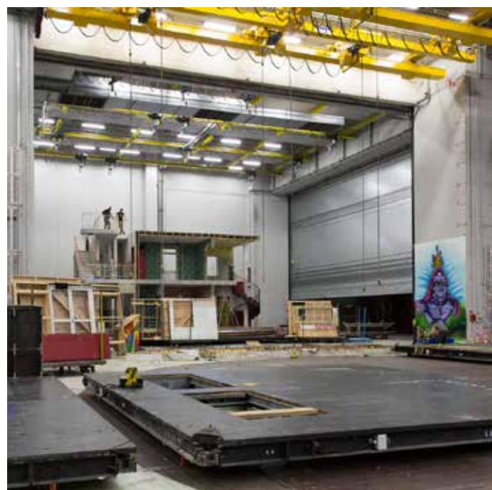
▲ Les chariots Marell, destinés au transport de décors entiers dans les espaces scéniques au niveau de l'aire de montage
