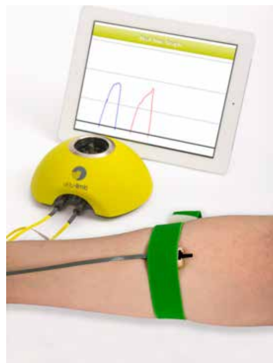
virtu-limb™ do pomiaru sygnałów mioelektrycznych
