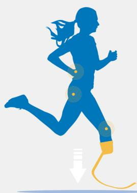
La courbe de la lame Cheetah se comprime à l'impact, emmagasinant l'énergie et les tensions qui devraient être normalement absorbées par le genou, la hanche et le bas du dos d'un athlète amputé.
