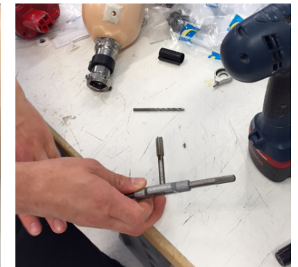
10. Gänga hålet med hjälp av gängtappen M10x1,5.
