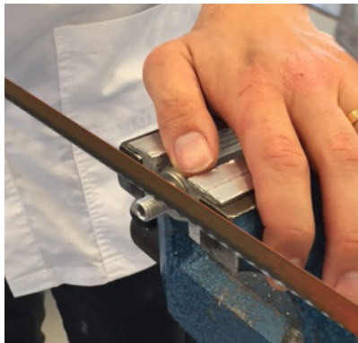
11. Kapa ventilen i korrekt längd.
