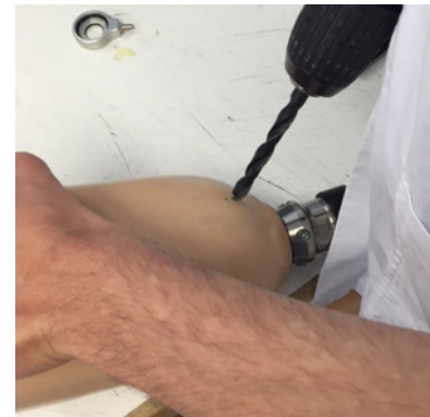
4. Borra ett hål i rätt vinkel mot hylsans vägg med en med 8,5 mm borr.
