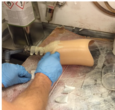
7. Lägg på 3-4 lager perlonslang/glasfiber (eller det som finns till hands) och stöppla med siegelharts.
