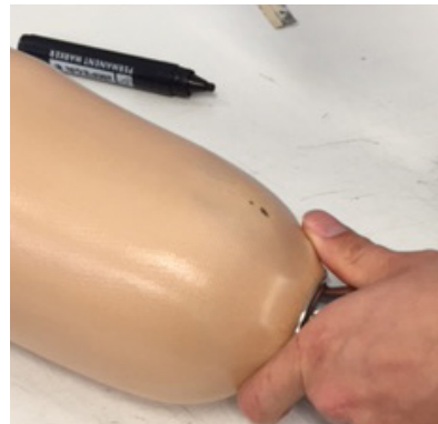
3. Kontrollera hylsväggens material-tjocklek. Borra hål i hylsans vägg (bild 4) och mät tjockleken vid monteringshålet med ett skjutmått. Tjockleken bör vara > 4 mm.
