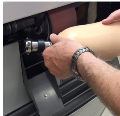
8. Slipa till en plan yta för ventilensätet.
