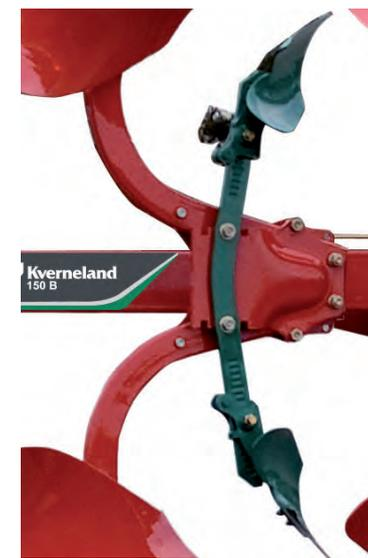
Leichtes und stabiles Hohlgrindel mit Scherbolzensicherung
