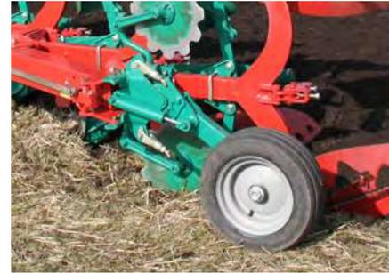
**Hinten angebautes Stützrad mit Teleskoparm**
