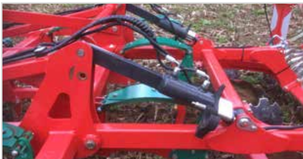
Die Tiefeneinstellung des Enduro erfolgt ebenfalls hydraulisch - über das Ein- und Ausschwenken von Distanzscheiben.
