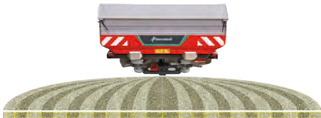
Vollständige Streubreite 54 m in max. 24 Abschnitten
