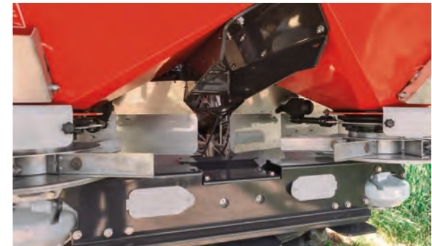
Ein elektrischer Stellmotor zur Steuerung der Ausbringmenge
