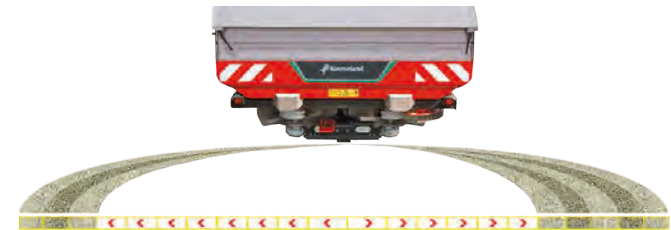
Abschalten der Teilbreiten von innen nach außen
