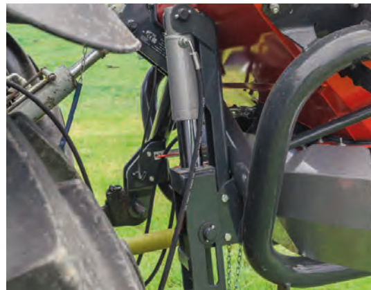
Grenzstreuen mit hydraulischem Schrägstellzylinder - Streuen in Richtung Grenze von der letzten Fahrgasse aus
