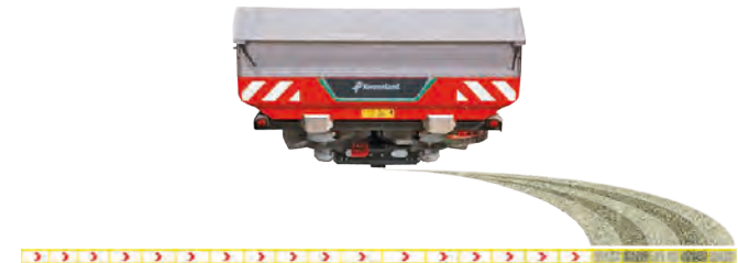
Abschalten der Teilbreiten von links nach rechts, sogar über die Mitte hinaus
