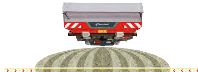
Verringern der Streubreite auf beiden Seiten um 8 m
