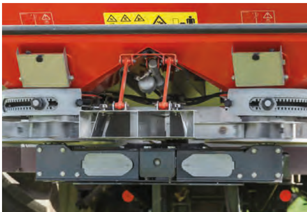
Einseitiges Grenzstreuen - Streuen von der Grenze aus mit der Grenzstreuplatte
