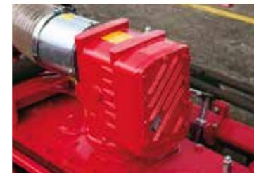
Die Gelenkwellen, die das Hauptgetriebe mit den Seitengetrieben verbinden sind gegen Überlast gesichert. Die Zinkengeschwindigkeit variiert von 336 bis 450 U/min bei einer Zapfwelldrehzahl von 1000 U/min. Die F35 ist mit einem Wechselgetriebe ausgestattet.
