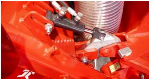
Schnell vom Feld auf die Straße und umgekehrt. Einfache Klappung von Arbeits- und Transportposition von der Schleperkabine aus.
