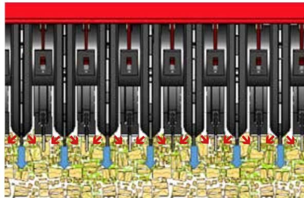
Die Konstruktion der Ringe und die speziellen Flankenwinkel der Actipackwalze ermöglichen eine optimale Rückverfestigung in der Tiefe, ohne die Bodenaggregate der oberen Bodenschicht zu verdichten. Zudem bietet das Profil eine gute Wetterfestigkeit und Feuchtigkeitstransfer.
