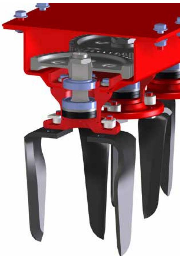
Die M-Serie von Kverneland ist eine mittelgroße Kreiselegge für Traktoren bis zu 140 PS. Sie ist das leichteste Modell der Kverneland Kreiseleggen-Baureihe, aber nicht nur der schwere Dreipunkturm folgt dem Konstruktionskonzept der robusten S-Serie, sondern auch die selbsttragende Wannenkonstruktion sowie die optionalen Schnellwechsel-Zinkenhalter und die doppelten konischen Lager bieten die optimale Leistung.
