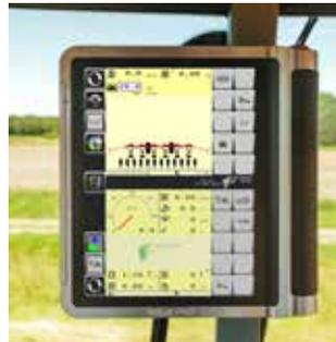
Mit e-drive II wird jede Säreihe individuell über einen Elektromotor angetrieben. Dank ISOBUS werden die Daten in der Schlepperkabine auf dem Terminal ausgegeben. Die Kornabstände können vom Terminal stufenlos eingestellt und während der Aussaat verändert werden. Jede Säreihe wird individuell ab-/angeschaltet, so dass Betriebsmittel und somit Geld einspart werden.
