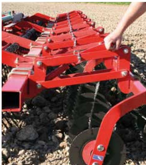
Der Druck auf die Krümmerwalzen kann mit Hilfe eines mitgelieferten Spanners eingestellt werden.
