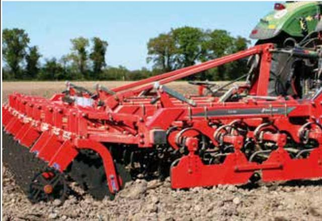
TLG ausgerüstet mit Clod Board und einer Krümmer-Crosskillwalzen Kombination
