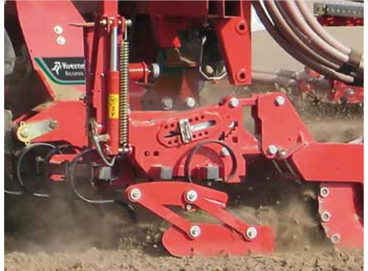
Die Access+ in Kombination mit den Kverneland Aufbaudrillmaschinen sorgt für einen günstigen Schwerpunkt der Maschine auch bei großem Tankvolumen (1.800 l).
