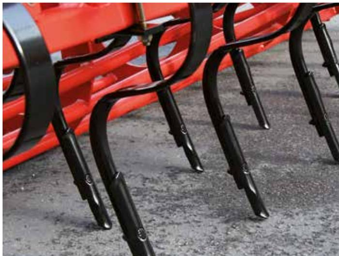
Die Kverneland Access+ kann mit zwei oder drei Reihen gerader Zinken 45x10 mm ausgestattet werden. Die geraden Zinken erlauben ein sorgfältiges Einebnen sowie eine gute Krümelung der Oberfläche zur Saatbettbereitung. Für Böden mit einem hohen Steinbesatz kann die Access+ mit zwei Reihen Schleppezinken ausgerüstet werden. Die zweireihigen Modelle können mit einer starren Planierschiene oder einem hydraulisch verstellbaren Clod Board ausgestattet werden.
