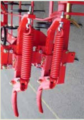
Nonstop Spurlockerer mit der Möglichkeit 2 Zinken zum lockern der Traktorspur anzubauen.
