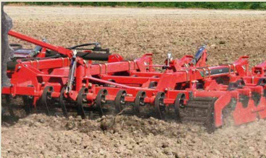
Die Planierschiene kann in Höhe und Arbeitswinkel verstellt werden; mit Hilfe einer Nonstop-Überlastsicherung kann die Schiene beim Auftreffen auf ein Hindernis ausweichen.
