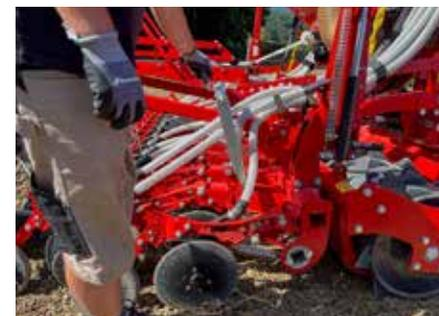
Der Schardruck lässt sich einfach mit einer Spindel einstellen. Es wird kein zusätzliches Werkzeug benötigt.
