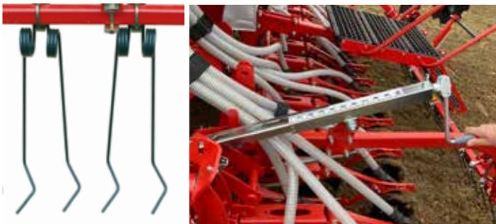
Der Druck und die Höhe des S-Zinken-Nachlaufstriegels werden mit einer Kurbel eingestellt. Auch der Winkel kann verändert werden, um die Aggressivität der Arbeit anzupassen.
