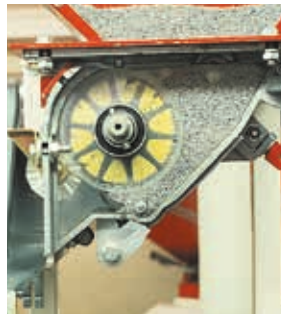
Einstellung für feines Saatgut (Kern eingeschoben)
