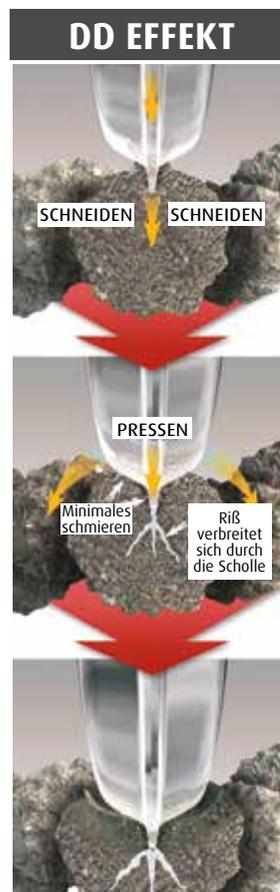
Durch die DD Keilringwalze werden Kluten zerbrochen und Risskanäle gebildet. Diese verbleiben zur weiteren Verwitterung für eine gute Bodengare.
