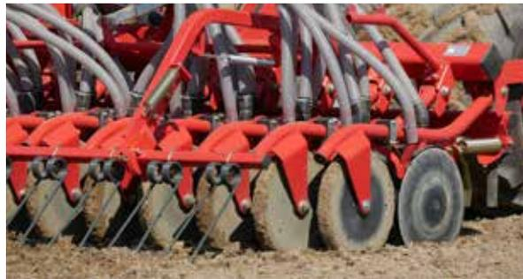
Dank des extrem schlanken Designs des CD-Doppelscheibenschares wird nur wenig Boden bewegt. Daher wird nur wenig Schardruck benötigt, um die gewünschte Sätiefe zu erreichen. So kann, falls erforderlich, mehr des Schardrucks (bis 100 kg) auf die Andruckrolle gegeben werden. Das Ergebnis ist eine sehr gleichmäßige Saatgutablage. Zur gleichzeitigen Ausbringung von zwei Saatgütern bzw. von Saatgut und Dünger steht das CD-Doppelscheibenschar mit zweitem Auslauf zur Verfügung.
