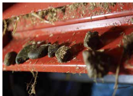
Einfaches Öffnen und Reinigen der Steinfangmulde.
