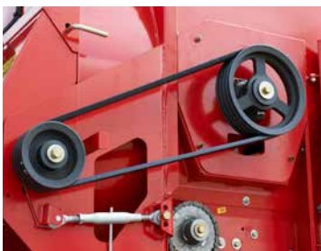
Keilriemenantrieb – Geringer Verschleiß und ruhiger Lauf.
