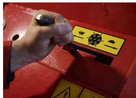
Einfaches Umstellen des Getriebes zum Einstreuen oder Füttern.
