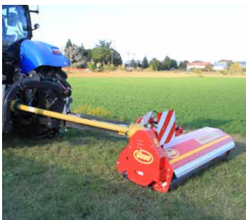
Böschungen Mulchen, Hecken- und Gehölzpflge mit bis zu + 90 Grad Arbeitsbereich.
