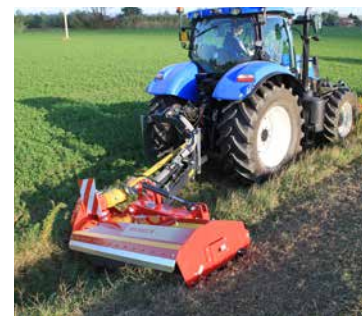
Bis zu – 65 Grad zur Graben und Böschungspflege.
