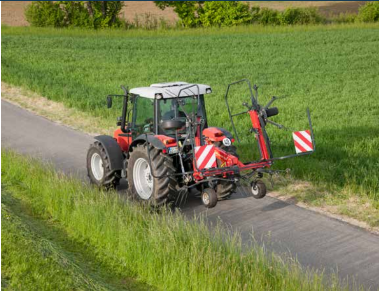
Die Kreiselzettwender werden hydraulisch von der Arbeits- in Transportposition und umgekehrt geklappt.
