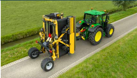
Der Vicon ROC RS 730 ist in Transportstellung nur 2,5m breit.
