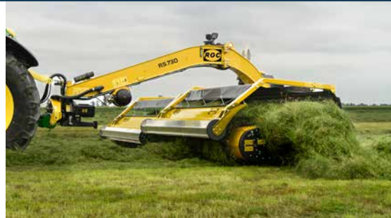
Durch die Rollenniederhalter wird das Futter immer sehr gleichmäßig gefördert, egal ob der Zuckergehalt hoch oder niedrig ist.
