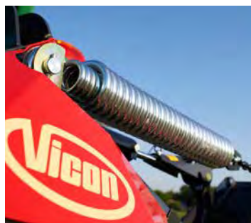
Die großen Spiralfedern sorgen für eine perfekte Boden Anpassung über die gesamte Arbeitsbreite.
