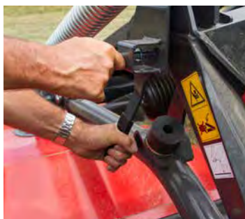
Zentrale Arretierung der Aufhängung zum Abstellen der Maschine.
