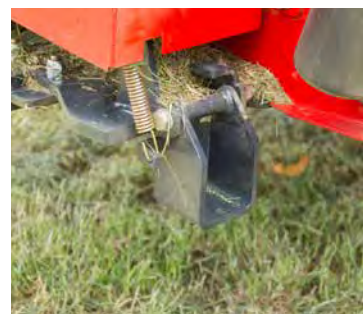
Durch den federbelasteten Abstellfuß steht das Mähwerk immer perfekt zum an- und abkuppeln.
