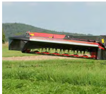
Ausreichend Aushubhöhe am Vorgewende.
