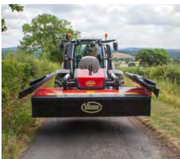
Hydraulische Klappung der seitlichen Schutzabdeckung (Option).
