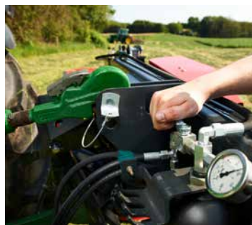
Der Auflagedruck kann auf dem Manometer abgelesen werden.
