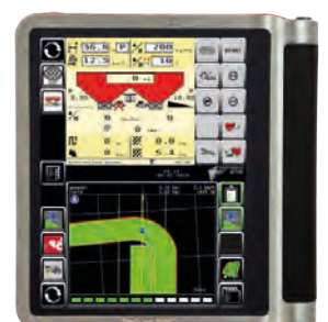
Automatische Drehzahlwarnung über das Terminal
