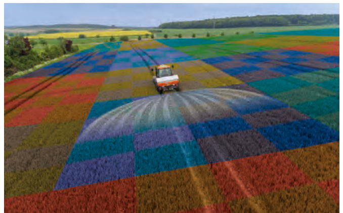
Variable Dosiermengensteuerung (MULTIRATE)
