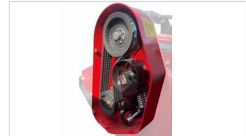
El tensor de correa automático BTS garantiza la transmisión estable del rotor en todas las condiciones de trabajo.
