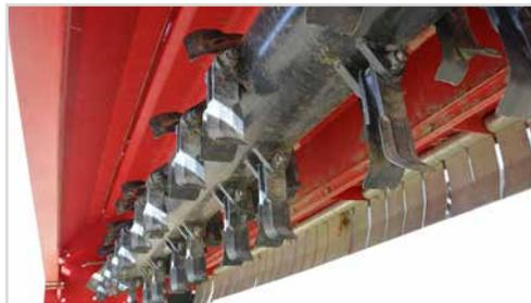
El diseño especial de los martillos y de las cuchillas universales o de abanico crea un efecto de succión que levanta el material y mejora el picado.
