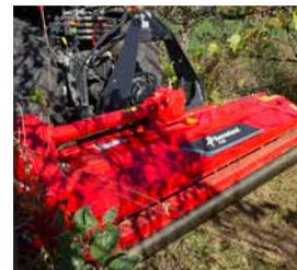
De serie monta un rodillo de 160 mm de diámetro con un rascador ajustable que garantiza el rendimiento correcto en el campo.
