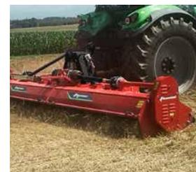
El grupo de transmisión, con ruedas libres hacia ambos lados, tracciona el rotor picador con correas y tensores automáticos, y así, minimiza el mantenimiento.
