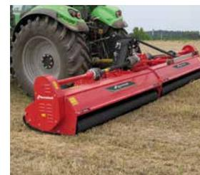
Ancho de trabajo de 5,6 a 6,4m. El rodillo trasero, incluido en el equipo básico de la máquina es Ø245mm con autolimpiado.
