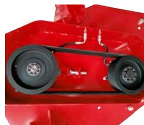
La FXZ siempre está equipada con una transmisión lateral doble. Los puntos de engrase externos y centralizados del rotor garantizan el mantenimiento más rápido.
