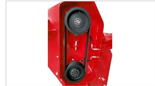
La transmisión lateral por correas de la gama de trituradoras está diseñada para transferir la potencia máxima necesitando de mínimo mantenimiento.
