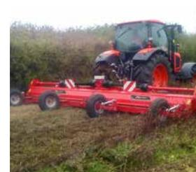
Las ruedas semi pivotantes (10/8,0 x 12,8 lonas), variante de configuración, garantizan la buena estabilidad y el control de la profundidad de trabajo.
