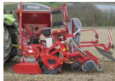
La profundidad de siembra, en la máquina básica, se ajusta manualmente con un par de manivelas situadas en los exteriores, y como variante de configuración puede solicitarse con ajuste hidráulico por medio de separadores sobre el vástago de los dos cilindros hidráulicos sin necesidad de herramientas.
