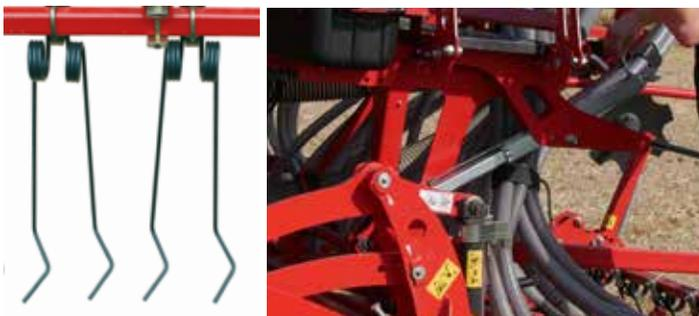
La presión y la altura de la rastrilla trasera de dedos en S se ajustan mediante una manivela. También se puede modificar el ángulo para personalizar la agresividad de trabajo.
