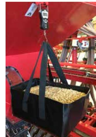
El Kit de calibración que se entrega con cada máquina consiste en una bolsa de calibración y una balanza digital. Las pruebas de calibración se realizan electrónicamente en lugar de manualmente.
