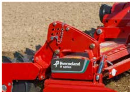
En las gradas rotativas rígidas, la profundidad de trabajo se ajusta mediante bulones y orificios. Un pasador cuadrado evita las rotaciones y la ovalización a la vez que amplía la zona de contacto, y minimiza el desgaste. Dispone de 18 ranuras diferentes para varias profundidades de trabajo. Los brazos del rodillo se han diseñado para los rodillos y sembradoras más pesados.
