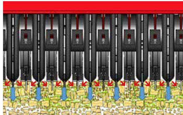
El diseño del anillo y el ángulo de los discos del rodillo Actipack proporciona consolidación a profundidad sin apretar los agregados de la superficie. Proporciona un buen efecto de intemperie y la transición de la humedad a través del perfil.
