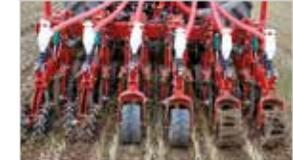
Las ruedas traseras de consolidación se apoyan sobre la franja trabajada, controlan la profundidad y retornan la densidad al suelo. La presión se puede ajustar mediante una manivela. Tres ruedas de consolidación diferentes ofrecen las alternativas necesarias para adaptarse a la variabilidad que ofrecen las condiciones cambiantes del suelo.
