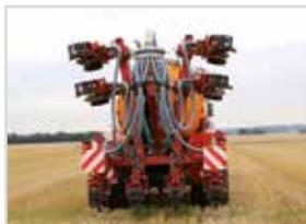
El chasis "F" del Kultistrip se pliega hidráulicamente en cuestión de segundos y está listo para pasar al siguiente campo. En posición de circulación, las partes plegables se bloquean hidráulicamente y los paralelogramos se bloquean mecánicamente para garantizar la máxima seguridad en la carretera.
