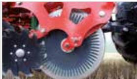
Los discos de corte delanteros abren el suelo y cortan residuos largos que luego retirarán fácilmente las estrellas limpiadoras.
