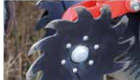
Las estrellas limpiadoras desplazan (barren, no trabajan el suelo) grandes cantidades de residuos fuera de la banda para obtener un lecho de siembra limpio. El efecto de limpieza de las tiras puede ajustarse mediante presión de muelle.
