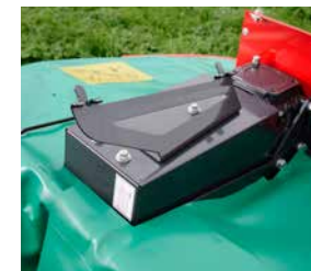
Formador de hileras accionado, que forma hileras uniformes de sección rectangular.
