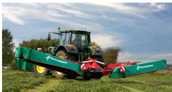
Amplia distancia libre respecto a las hileras durante los giros en cabecera.
