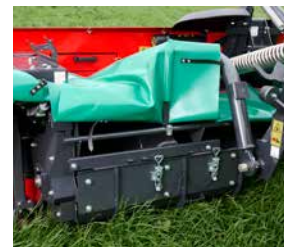
Formador de hileras accionado, que forma hileras uniformes de sección rectangular.
