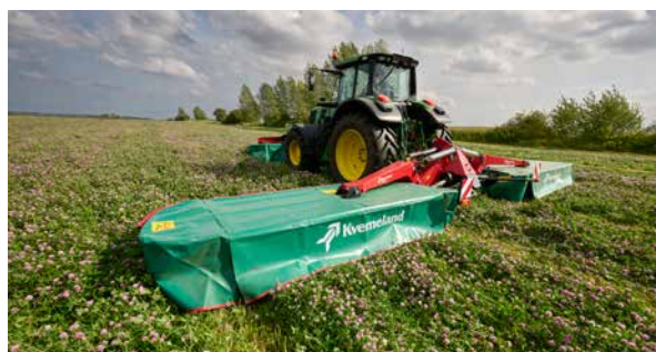
Diseño con suspensión central para una excelente adaptación al terreno.
