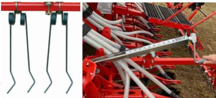
La presión y la altura de la rastrilla trasera de dedos en S se ajustan mediante una manivela. El ángulo también se puede modificar para adaptar la agresividad de la labor.
