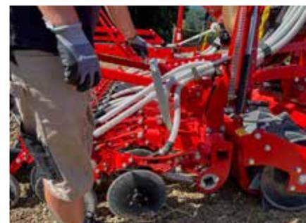
La presión de los discos de siembra puede ajustarse fácilmente mediante una manivela. No se necesitan herramientas adicionales.
