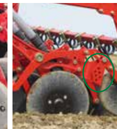
Ajuste de la rueda de consolidación levantada
