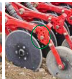
Ajuste flexible de la rueda de consolidación
