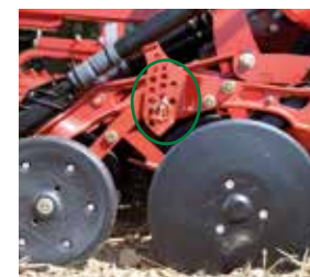
Ajuste flexible de la rueda de consolidación
