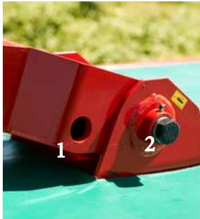
Dos posiciones de montaje de la barra de corte en la suspensión para un solapamiento óptimo.
