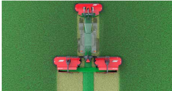
Una hilera central de un ancho de trabajo de 10,20 m.
