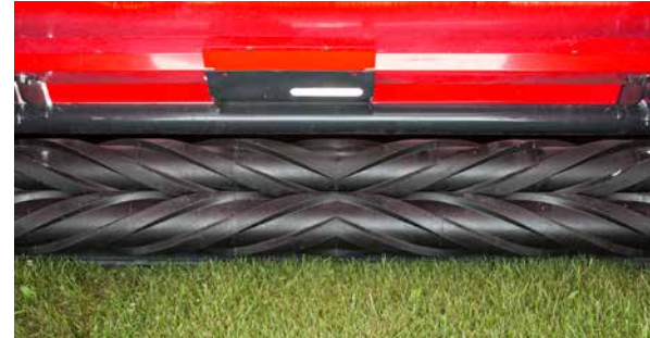
Transmisión activa de ambos rodillos
