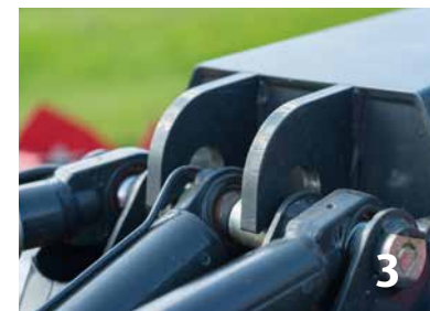
Al bajar las unidades de corte, la cinta BX se desacopla automáticamente.
