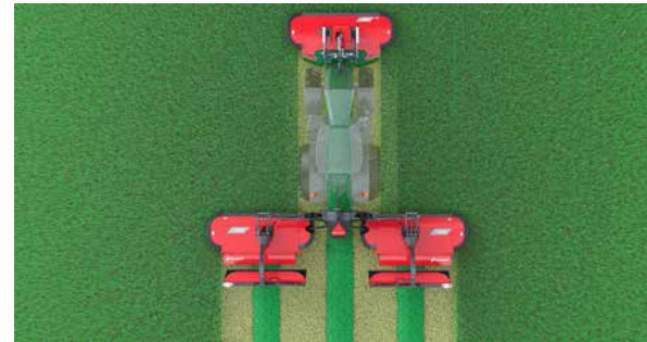
Tres hileras individuales, utilizando las chapas hileradoras integradas.
