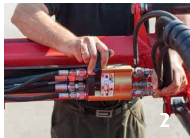
Desconecte el cable de alimentación y todas las conexiones hidráulicas de la cinta BX mediante una única palanca.
