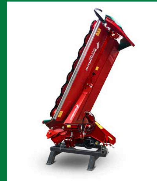
Soporte de estacionamiento opcional para un almacenamiento fácil y compacto.
