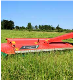
Suspensión central para una distribución uniforme del peso a lo largo de todo el ancho de trabajo.
