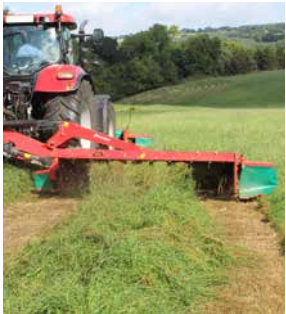
El gran muelle garantiza una flotación excelente a lo largo de todo el ancho de la segadora.
