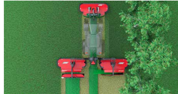
Uso de una sola cinta para desplazar el cultivo desde los límites del campo.
