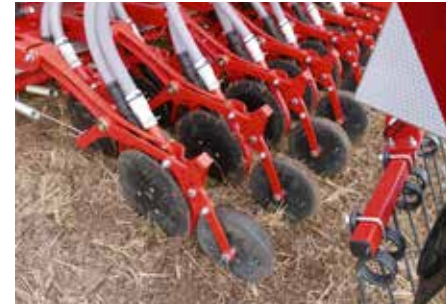
Discos CX-II con doble descarga - dos aportes en una sola pasada.
