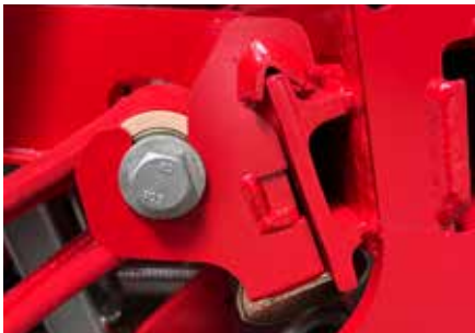
Bridas de los discos CX-II - flexibilidad en la distancia entre hileras.
