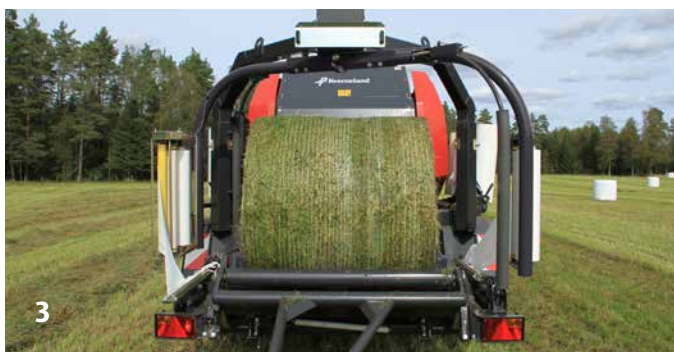
3 Aussitôt la balle sortie de la presse, la porte se referme automatiquement et le pressage peut reprendre.
