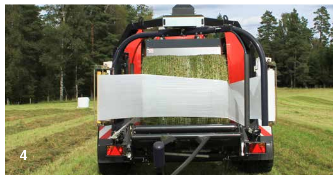
4 La table d'enrubannage se déplace rapidement vers les pré-étireurs et l'enrubannage démarre immédiatement.
