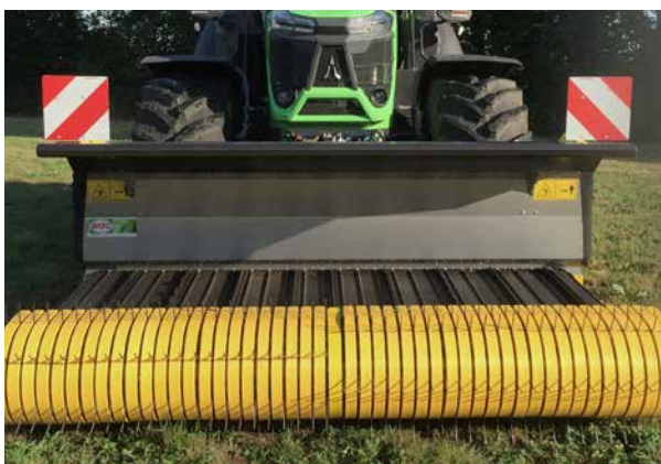
Largeur de travail 3,8 m et largeur de transport 2,95 m.
