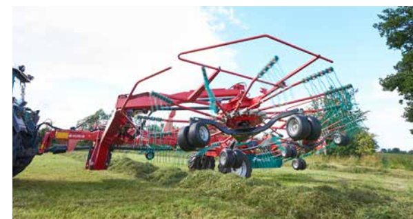
La hauteur de levage importante des rotors assure un dégagement généreux en fourrière.
