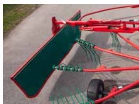
Repliement automatique de la planche à andains et béquille de stationnement.
