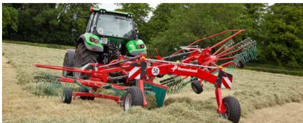
Andainage avec un seul rotor en équipement standard.
