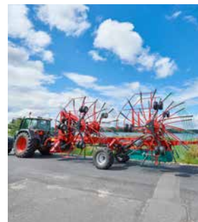
Hauteur de transport inférieure à 4,0 m, même sans retirer les bras porte-dents.
