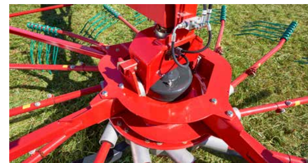
La hauteur de travail de chaque rotor peut être réglée indépendamment et hydrauliquement.
