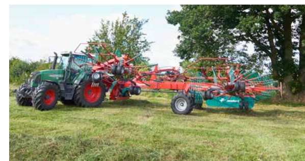
Les 4 rotors peuvent être soulevés individuellement.
