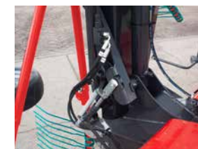
Verrouillage hydraulique au transport (option).
