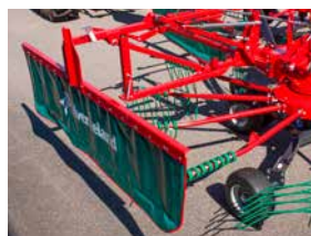
Repliement automatique de la planche à andains et béquille de stationnement.
