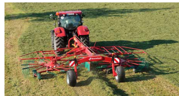
Le Kverneland 9584 C avec une largeur de travail de 8,40 m, un boîtier d'entraînement entièrement fermé et une largeur de travail réglable hydrauliquement.
