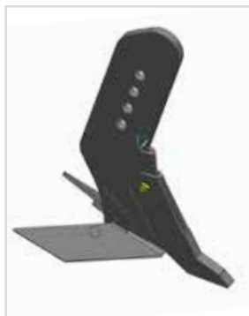
La dent LD ameublie sans lisser en profondeur. Le sol se referme directement derrière la dent.
