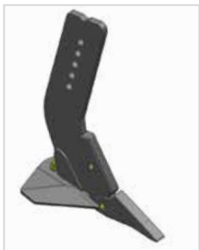
La dent Pro-Fit est disponible avec 3 différents ailerons afin de s'adapter aux différents types de sols, la dent est composée en tout et pour tout de 4 pièces d'usures toutes démontables indépendamment les unes des autres.
