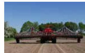
Sur la route, grâce à ses roues de 800 mm de largeur, le DG II dispose d'une très bonne stabilité. Avec une largeur de 3 mètres et une hauteur de 4 mètres, ses dimensions sont dans des normes de réglementation de circulation européennes.
