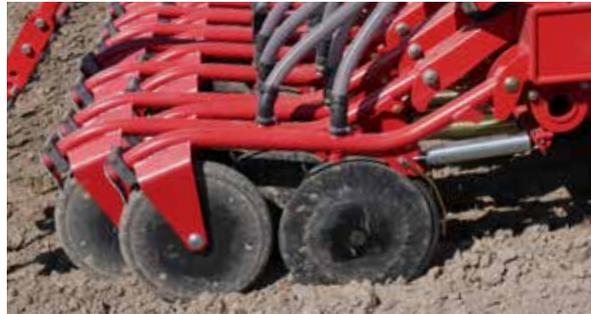
L'élément semeur CD dispose d'un angle d'attaque très réduit afin d'éviter les projections de terre et atteindre la bonne profondeur de semis. Ainsi, la pression peut être appliquée sur la roulette plumbeuse si nécessaire.
