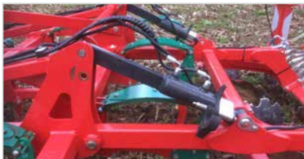
Le rouleau arrière de l'Enduro n'est pas relié par un parallélogramme et est réglable hydrauliquement par des cales d'espacement.
