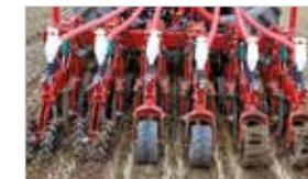
Les roues de rappui consolident la bande travaillée. La pression peut être réglée par une manivelle. Trois roues plombeuses différentes permettent de s'adapter à toutes les conditions de sol.
