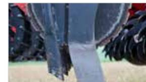
Deux options de tube de fertilisation sont disponibles. Une plus petite utilisée pour l'engrais minéral en granulés et une plus grande (60 mm) pour l'injection de boue. Réglage de la profondeur (0-20 cm) indépendamment de la profondeur de travail. L'engrais est placé pendant le travail de la bande.
