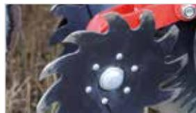
Les chasses débris déplacent des grosses quantités de résidus, pour avoir une bande propre et permettre le travail de la dent sans blocage. Le travail effectué peut être réglé en ajustant la pression des ressorts.
