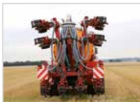
Le châssis du Kultistrip se plie hydrauliquement en quelques secondes, prêt à passer au champ suivant. En position de transport, les parties repliables sont verrouillées par l'hydraulique et les parallélogrammes sont verrouillés mécaniquement afin d'assurer une sécurité maximale sur la route.
