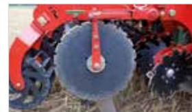
Les disques latéraux de Ø460mm retiennent la terre meuble dans la bande et définissent la largeur et la forme de celle-ci, grâce aux réglages de l'angle et de la profondeur du disque.
