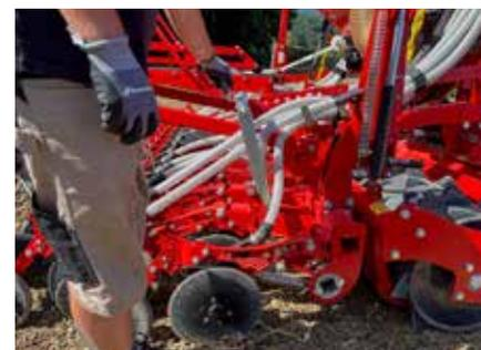
Ajustement de la pression en continu de l'élément semeur de 1 à 50 kg.
