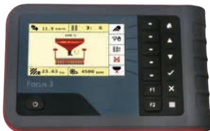
Le terminal Focus 3, équipé de l'électronique e-bas, permet de contrôler toutes les fonctions du semoir : densité de semis, calibration, gestion du jalonnage, information des capteurs de fond trémie, de turbine... Le Focus 3 est un terminal couleur simple écran qui s'installe en cabine. Cependant, il n'est pas compatible ISOBUS et ne permet pas la coupure de doseur en fourrière ni la modulation.
