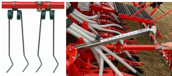
Réglage de la hauteur de la herse de recouvrement et de sa pression
