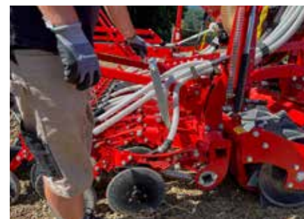
Ajustement de la pression en continu de l'élément semeur de 1 à 50 kg.
